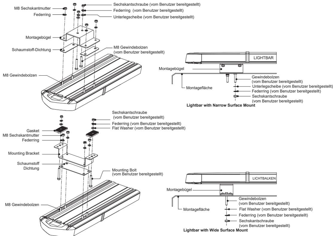
4. Bringen Sie den Lichtbalken an der gewünschten Stelle an und stellen Sie die beiden Halterungen je nach Bedarf nach innen oder außen ein. Versuchen Sie nach Möglichkeit, die Halterungen nah an den Enden des Lichtbalkens zu platzieren.
