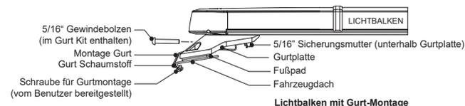
3. Bringen Sie den Gurt an der in der Abbildung gezeigten Stelle auf dem Dach an.
